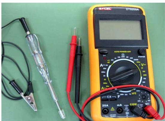
まずは、装置を取り付ける時に必要になるテスター(写真右)か電検ペン(写真左)をご用意ください。配線の接触不良などの通電確認や、車の信号を確認するのに必要になります。
