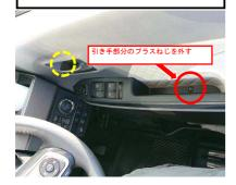
ミラー内側のパネルを外します。 後部側ツメとクリップ2箇所を引き剥がします。
