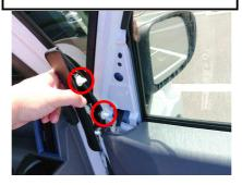
スイッチパネルを外します。 ツメだけでクリップはありません。 後ろから引き上げると外しやすい。
