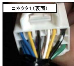
コネクタ1(結線先配置図※配線が出ている側)
