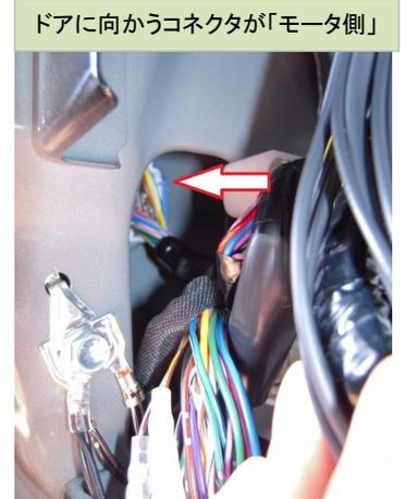
※配線カバーを剥き、茶+黄、赤+灰線を切断
