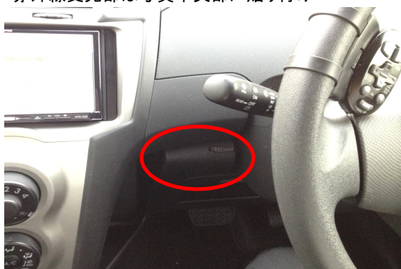
赤外線受光部は写真中央部に貼り付け
