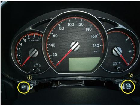
黄色丸のネジを取り上部のクリップ止め部分を外す
