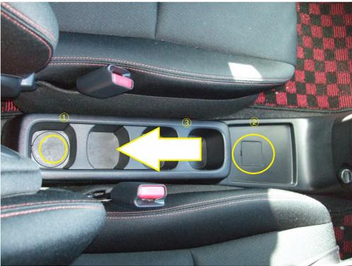
黄色丸の部分カバーをはずしネジを取り車両後方にスライドさせる
