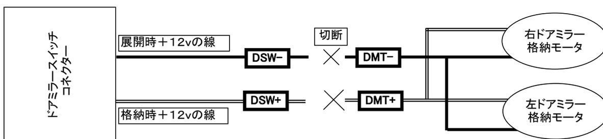
6. 上記4本の信号線を、本器の対応する線と接続しますが、DSWとDMTを逆結線してしまうとショートして装置破損、あるいは、車両側ヒューズが切れてしまいます。これを防止するために以下の手順で結線先が正しい事を確認をお願いします。
