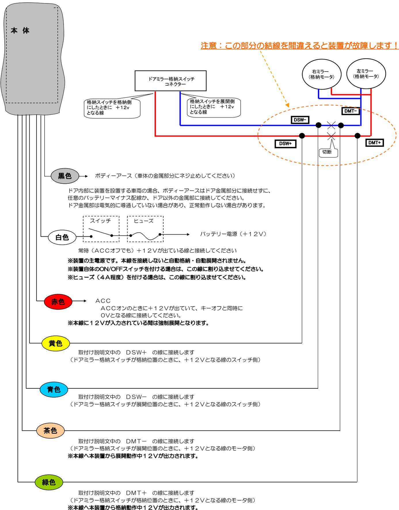
ドアミラー格納スイッチからの配線は細い場合が多いので、DSW、DMTの接続はギボシ端子等を用いて確実に接続してください。
