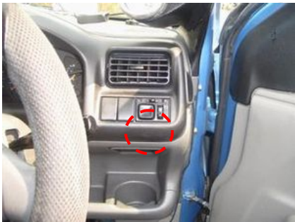
運転席ハンドル右側ミラー調整スイッチのコネクタ ※ドリンクホルダー上にあるフタを外せばコネクタの脱着可能
