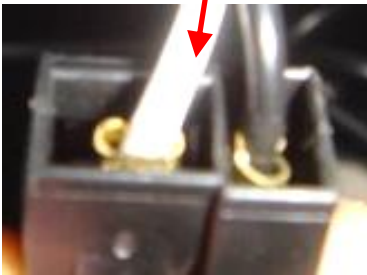
コネクタ5 ヒューズボックス最下段左端付近
