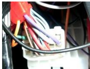
4ピン(薄茶色) ドアアンロック 17ピン(灰) ドアロック 12ピン(赤) 再ロック条件信号線
