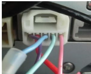
1ピン(桃) ドアアンロック信号線 3ピン(水色) 車速信号線
