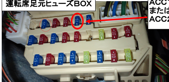
ドアアンロック条件信号線2 Pポジション信号(緑+黄) 奥側左から1番目
