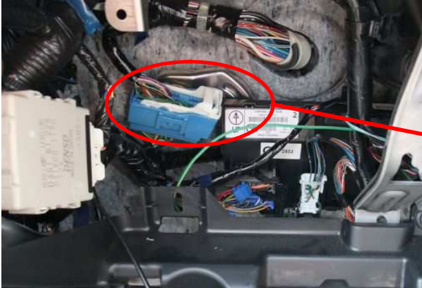
コネクタ5(グローブボックス裏のECUに接続されているコネクタ)
