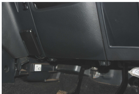
ハンドル下のインパネの取り外し 2本ビスを外し下側を手に引く
