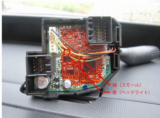
No5 写真:ライトスイッチ裏側(コネクタ1)
