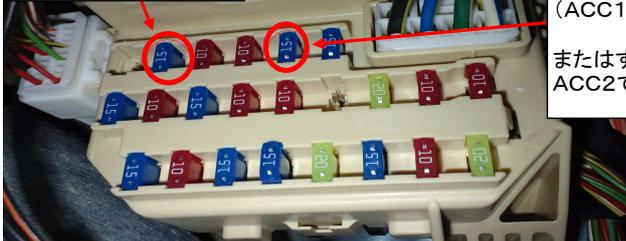
アクセサリ電源 分岐接続 (ACC1) 15A
