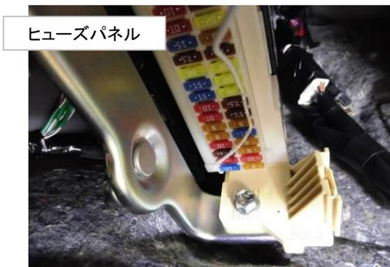
アクセサリ電源はグローブBOX奥のヒューズパネル内から市販の電源取り出しヒューズを使用して、シガー(SIG)等のACC電源から取り出してください。
