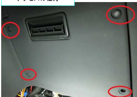
赤丸四箇所のクリップを外します。 このクリップは真中の穴を押し込むと外せます。
