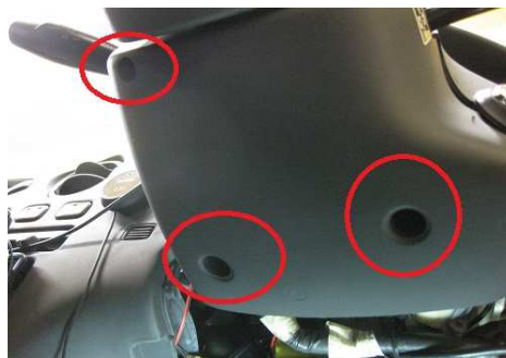
赤丸3箇所のネジを外すと ハンドルコラムカバーが外せます。
