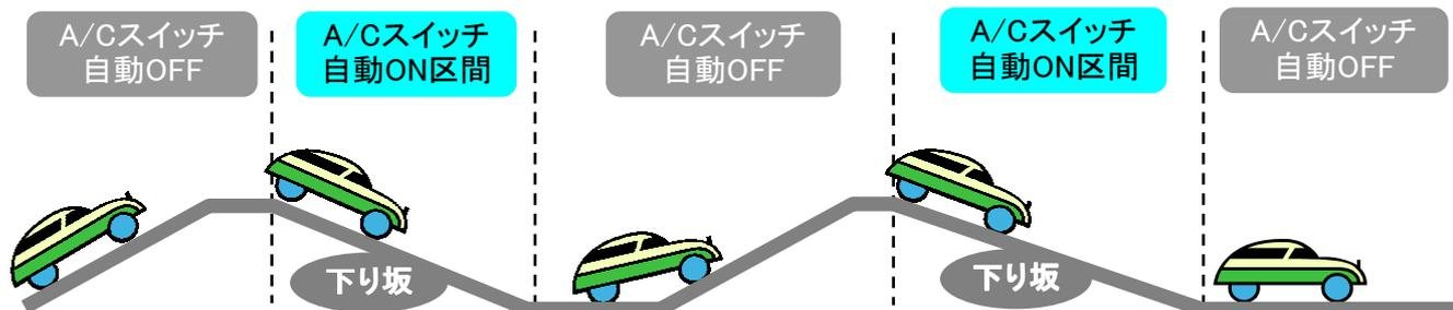
傾きセンサーを搭載しているのです、下り坂などでは A/Cボタンを自動的にON に切り替えてエアコンによる冷房を行います。 上り坂、平坦な道路ではA/CボタンをOFFに切り替えて、エアコンによる負荷をなくします。 ※どの程度の下り坂で作動するかは、本体の設置角度で変わります。 進行方向側を若干上向き設置します。
