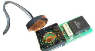
④ ③で銅プレートを張り付けたアダプターをスマートキー本体の電池ホルダーに装着します。
