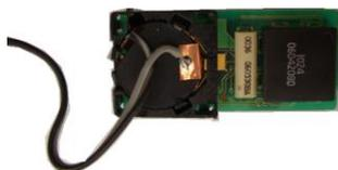
⑤アダプターを装着した際に、アダプターに取り付けた配線が他の所に接触しない様に配線を取り回してください。
