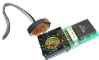
④ ③で銅プレートを張り付けたアダプターをスマートキー本体の電池ホルダーに装着します。
