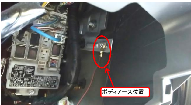
ボディアース例(ヒューズBOX右側、ネジを利用しナットで合締め)
