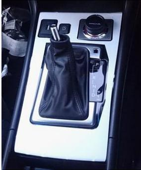
シフトノブを回して取り外し、シフトブーツを押し下げます。
