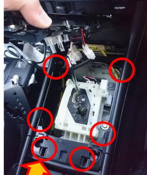
矢印の位置からリムーバーを差し込み、赤丸のツメの位置に気を付けてシフトカバーを取り外します。
